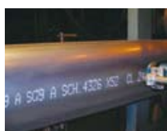
鋼管へのマーキング
