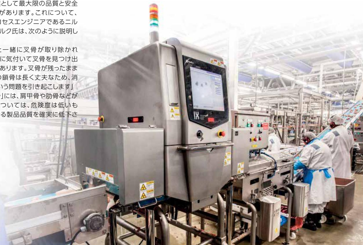
胸肉は、同じ密度の繊維がすべて同じ方向を向いているため、筋肉と脂肪の密度が大幅に異なる骨なしモモ肉に比べ、X線検査装置にそれほど大きな課題を呈するわけではありません。1台のIX-G2で、ハーランド工場の骨抜きモモ肉の組み合わせを監視し、それらが基準を満たしているかどうかを確認できます。
