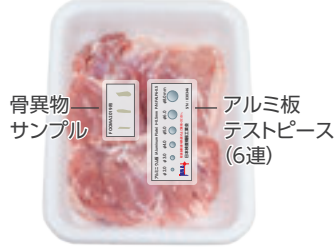
2種の異物サンプルを貼り付けし、従来機と感度を比較
