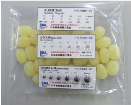
确定不锈钢、玻璃、橡胶和异物的位置。
