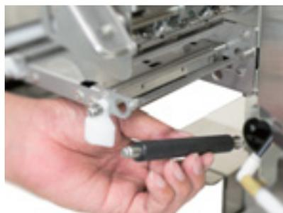
交換が簡単な印字ローラーやサーマルヘッド (写真は印字ローラー)
