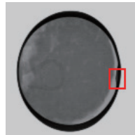
縁部分での高感度検査に加え、缶の凹み検査も可能
