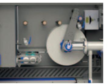
Интегрированная система газосмещения, а также анализа и кодировки полученной среды
