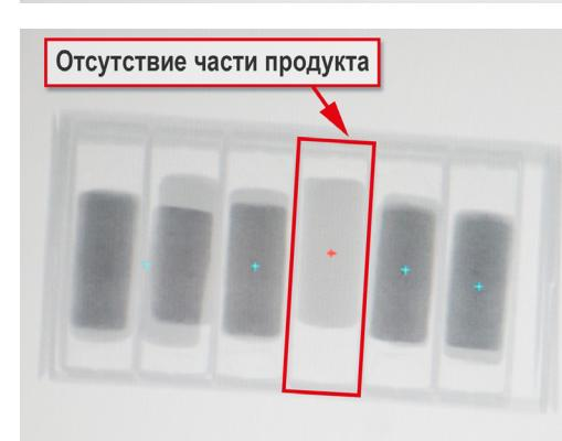
“ Система рентгеновского контроля может успешно определять наличие всех возможных видов посторонних включений, что является важнейшей проверкой на безопасность. Это особенно важно при производстве продуктов питания для детей. ”
