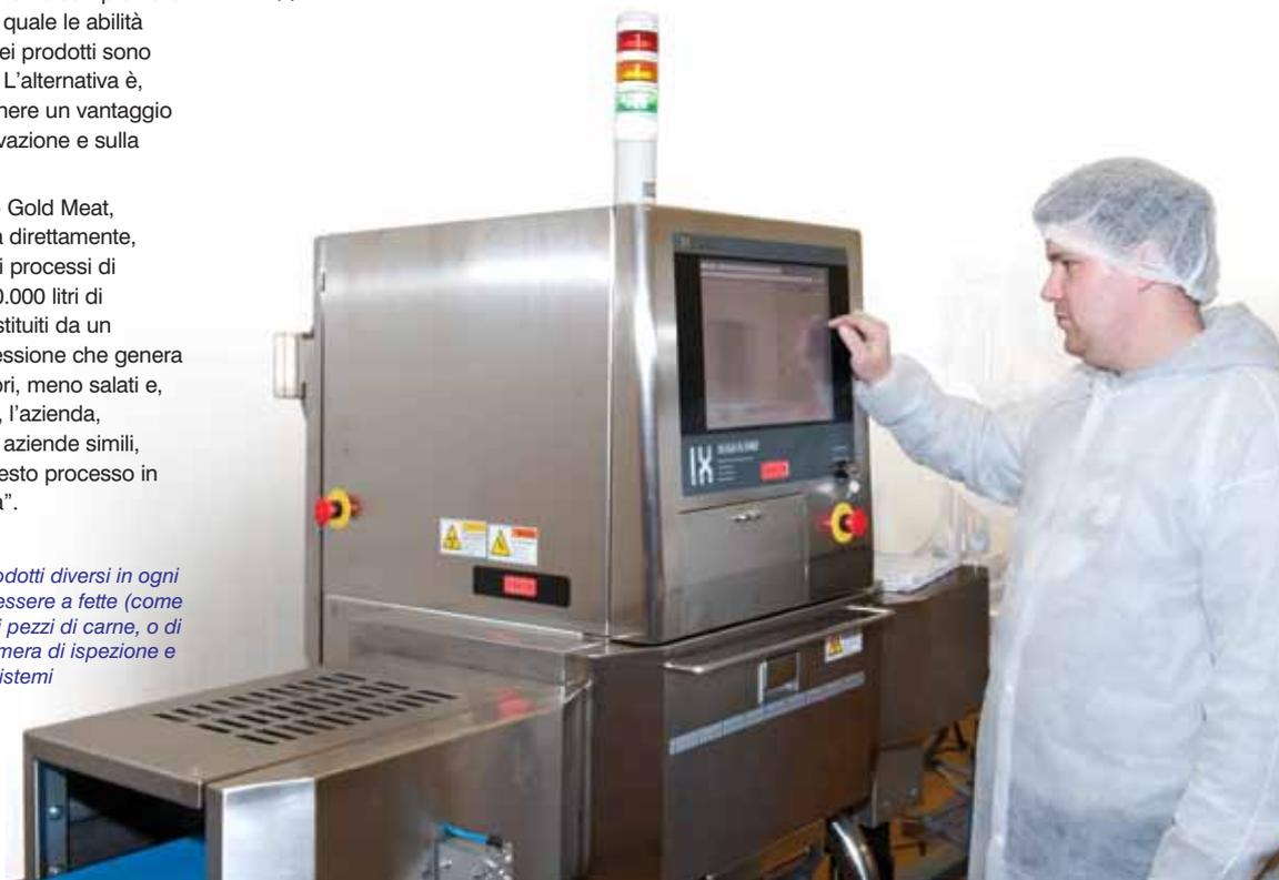
migliorano l'immagine vengono mantenute, mentre le altre vengono scartate; in questo modo, il risultato della scansione che sarà visualizzata all'operatore diventerà sempre più chiaro. Grazie all'inserimento di un particolare contaminante di prova, il sistema potrà essere impostato a un livello di sensibilità specifico per tale contaminante.
