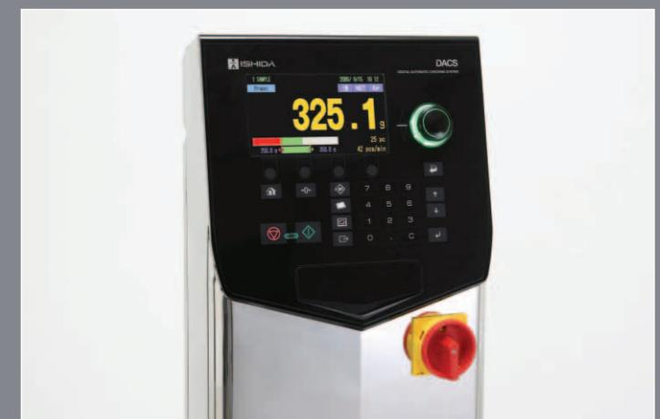
Cadran de commande manœuvrable par simple 'rotation-pression', sans qu'il soit nécessaire de retirer les gants
