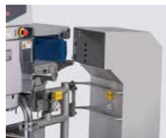
Das Design der Schutzvorrichtungen und Auswurfbehälter ermöglicht einen einfachen Zugang.
