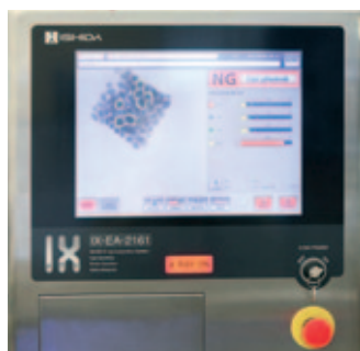
Рентгеновская система контроля Ishida IX-EA-2161 распознает мельчайшие по размеру посторонние вещества в упаковках кондитерской продукции: металл, стекло, камень, резину и пластмассу.
